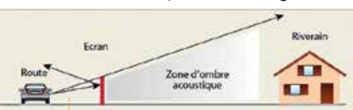
Principe de fonctionnement d'un écran acoustique.
