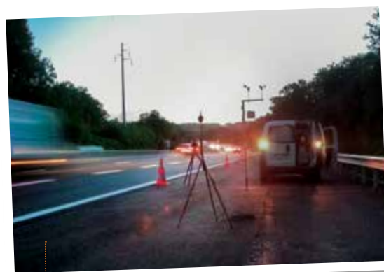
Dispositif de contrôle de performance acoustique des enrobés.
